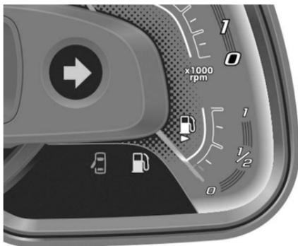
Al activar la ignición, el medidor de combustible muestra cuánto combustible queda en el tanque. Una flecha en el medidor de combustible indica de que lado del vehículo se encuentra la compuerta del tanque. El medidor indica que está vacío antes que el vehículo se quede sin combustible, para alertar que el tanque de combustible del vehículo debe llenarse pronto.
