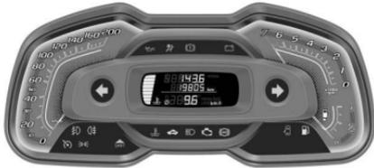
En el grupo del tablero de instrumentos se puede ver: velocímetro, tacómetro, indicador de combustible, temperatura del refrigerante del motor, indicadores direccionales y luces indicadoras.
