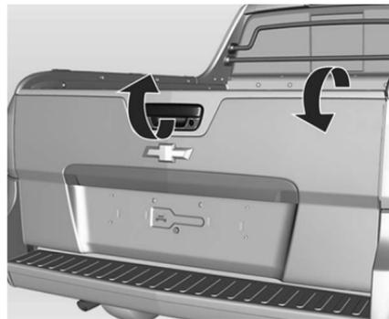
Para abrirla, jale la manija central y baje la tapa. Para cerrarla, levante la tapa y presione sobre los extremos superiores hasta que se escuche un ruido de bloqueo.
