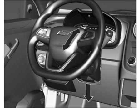
Desbloquee palanca, ajuste altura del volante, después enganche la palanca y asegúrese de que esté totalmente bloqueada.
