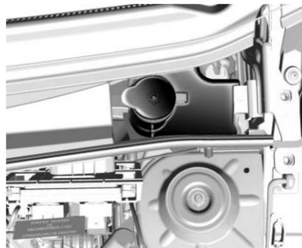
El depósito de líquido del sistema de lavado del parabrisas se encuentra ubicado del lado izquierdo del compartimento del
