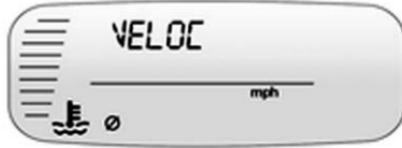
La pantalla de velocidad promedio del vehículo muestra la velocidad promedio del vehículo, en millas por hora (mph) o en kilómetros por hora (km/h).
