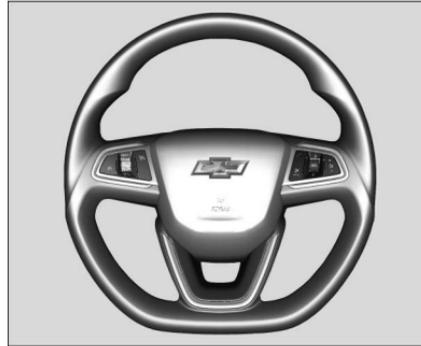
Este sistema se identifica con la inscripción "Airbag" en el volante (lado del conductor) y arriba de la guantera (lado del pasajero), además de la etiqueta adhesiva en la zona lateral de la puerta, lado del conductor.
