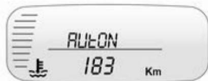
La pantalla de Rango de combustible muestra la distancia aproximada que se puede conducir el vehículo sin cargar combustible. El estimado del Rango de combustible se basa en un promedio del consumo de combustible del vehículo en la historia reciente y la cantidad de combustible que resta en el tanque. El Rango de combustible puede ser restablecido manteniendo el botón **R** presionado por 2 segundos.
