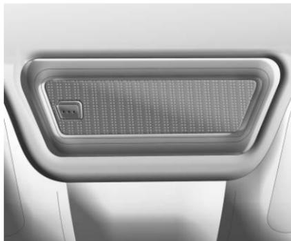
La luz se encenderá automáticamente cuando se abra cualquier puerta y se apagará después de un momento después que se cierran las puertas. Si desea apagar la luz con la puerta abierta presione el botón sobre la luz. Puede encender o apagar la luz manualmente sólo presionando este botón.
