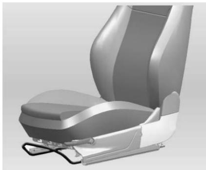
**Para levantar :** Aligerar el peso y jalar de la palanca hacia arriba.
