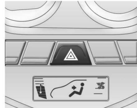
Presione este botón localizado en el tablero de instrumentos cerca del sistema de control de clima para encender y apagar las luces intermitentes de las direccionales delanteras y traseras. Esto advierte a otros que tiene una emergencia y se deben usar con el vehículo detenido. Presione nuevamente para apagar las intermitentes.
