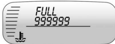
Este mensaje se muestra durante 5 segundos cada vez que la ignición se enciende si el odómetro se desborda (superior a 999999 kilómetros o millas).
