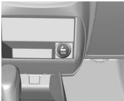
Con la ignición encendida, presione el encendedor de cigarrillos. La calefacción cesa automáticamente una vez que el elemento está brillando. Retire el encendedor para su uso.
