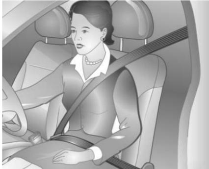
Extraiga el cinturón de seguridad y fíjelo en el broche. El cinturón de seguridad no debe estar retorcido y debe quedar bien ajustado al cuerpo. El respaldo no debe estar demasiado reclinado.
