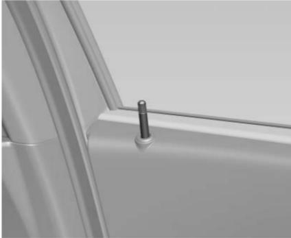
Para hacer funcionar las cerraduras de las puertas desde el interior, presione los pasadores de seguridad. Si la puerta del conductor se bloquea inadvertidamente al cerrar, la palanca volverá a la posición de desbloqueo. Esto evitará al vehículo se bloquee con la llave dentro.
