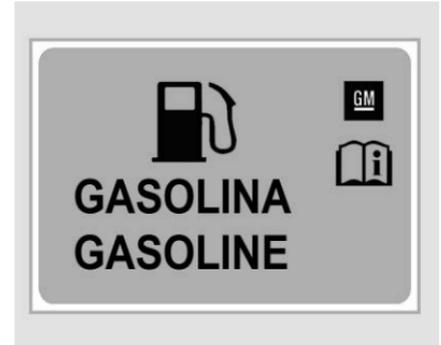
La etiqueta adhesiva anterior contiene una indicación del tipo de combustible y está ubicada en la lengüeta de relleno de combustible del vehículo.
