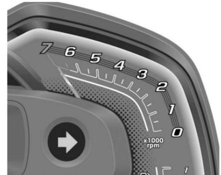
El tacómetro indica la velocidad del motor en revoluciones por minuto (RPM) (la lectura correcta se realiza multiplicando el número indicado por 1000).
