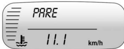
Aparece este mensaje y suena una campana si el sistema de enfriamiento del motor llega a temperaturas de funcionamiento inseguras. Deténgase y apague el vehículo lo más pronto posible para evitar daño severo. Este mensaje se borra cuando el motor se ha enfriado a una temperatura de funcionamiento segura.
