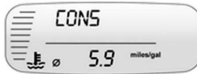
La pantalla de consumo promedio de combustible muestra el promedio aproximado en millas por galón (mpg), kilómetros por litro (km/l) o litros por cada 100 kilómetros (l/100 km).
