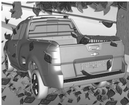
Evite estacionarse sobre pasto seco, arbustos, gotas de combustible u otro material inflamable cuando el sistema de escape esté caliente. Dependiendo de la situación, puede causar un incendio.
