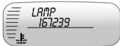
Este mensaje se muestra si un foco del señalador de vuelta necesita ser reemplazado.
