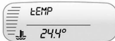
El indicador de temperatura del aire exterior muestra la temperatura del aire ambiente exterior.
