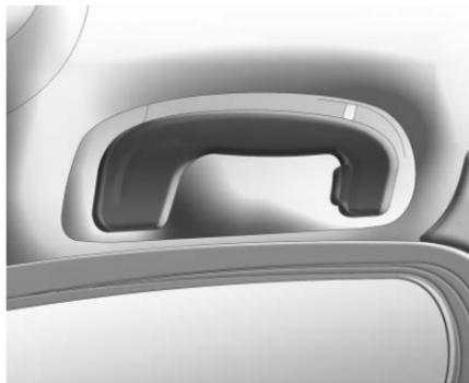
La manija de seguridad está fija en el techo por encima de la puerta del pasajero. Para utilizarla, júlela hacia abajo, regresa automáticamente a su posición original después de su uso.
