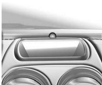
El sensor de luz está ubicado en la parte superior del tablero de instrumentos y enciende/apaga los faros de luz baja cuando el interruptor está en modo AUTO (automático).
