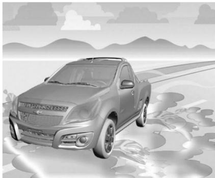
Ya que se puede acumular demasiada agua debajo de sus llantas en realidad pueden desplazarse sobre el agua y esto es peligroso. Esto puede suceder si el camino está muy mojado y usted va a una velocidad considerable. Cuando su vehículo está hidroplaneando, cuenta con muy poco o ningún contacto con el camino.
