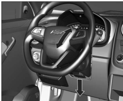
Desbloquee palanca, ajuste la altura del volante, luego enganche la palanca y asegúrese de que esté completamente cerrada.
