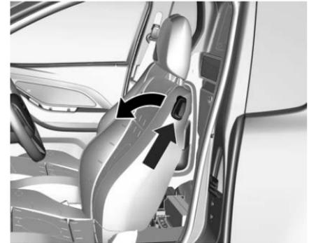
Para plegar el respaldo mueva la palanca de liberación, ubicada en el lado exterior superior del respaldo, hacia arriba y simultáneamente, jale el asiento hacia adelante.
