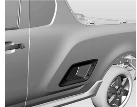
Hay dos estribos laterales que hacen más fácil el acceso a la cubierta de carga desde la parte lateral del vehículo. Además de estos estribos laterales, también se puede utilizar la defensa trasera para facilitar el acceso a la plataforma de carga. La capacidad de carga sobre los estribos es de 120 kg.
