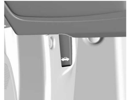
Para abrir el cofre del motor, jale la palanca de control de la cerradura (ubicada del lado izquierdo), debajo del tablero de instrumentos.
