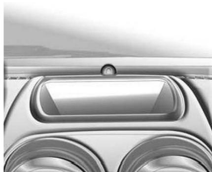
Cuando se activa el sistema de alarma antirrobo, la luz permanece encendida durante unos 10 segundos y comienza a parpadear indicando la activación del sistema.
