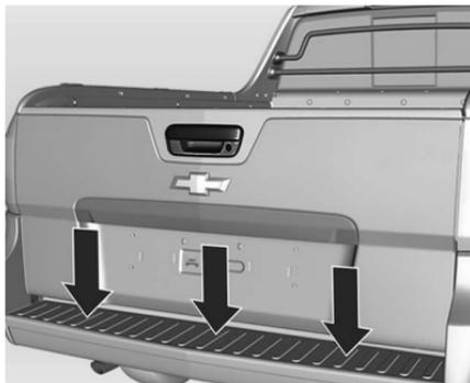
La carga máxima sobre el parachoques trasero es de 100 kg.
