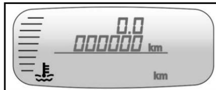
Muestra la temperatura del refrigerante del motor.
