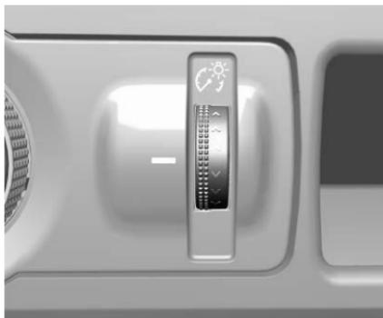
Esta función controla el brillo de las luces del tablero de instrumentos.
