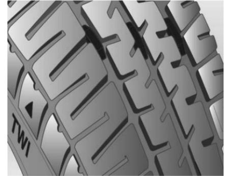
Por razones de seguridad, las llantas deben ser reemplazadas cuando la profundidad de su huella se haya desgastado hasta cerca de los 3 mm.
