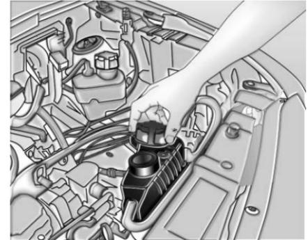
El sistema de refrigeración del motor se llena con un aditivo de larga duración para el radiador (glicol etileno) cuyas propiedades ofrecen una protección adecuada contra la congelación, ebullición y corrosión.
