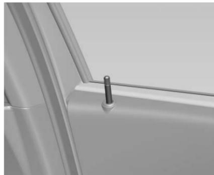
Para vehículos sin sistema de bloqueo central, las puertas se pueden bloquear individualmente por medio del "pasador" estando la puerta abierta o cerrada, con excepción de la puerta del conductor que sólo se puede bloquear con el pasador si la misma se cierra para evitar el olvido de la llave dentro del vehículo.
