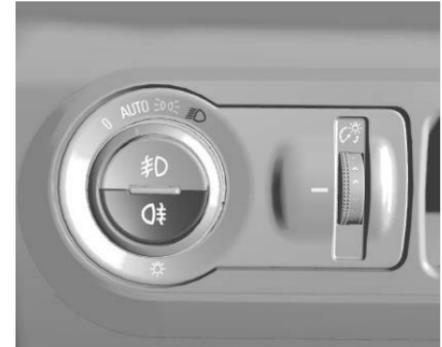
Para vehículos equipados con luces anti-niebla traseras, el botón se encuentra ubicado en el control de luces exteriores, del lado externo del tablero de instrumentos.
