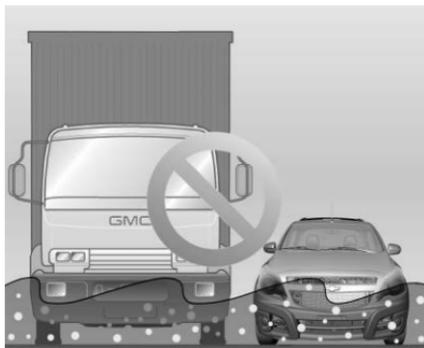
Cuando se requiera conducir a través de cualquier área inundada, hágalo a baja velocidad, alrededor de 10 km/h en 1ra velocidad.
