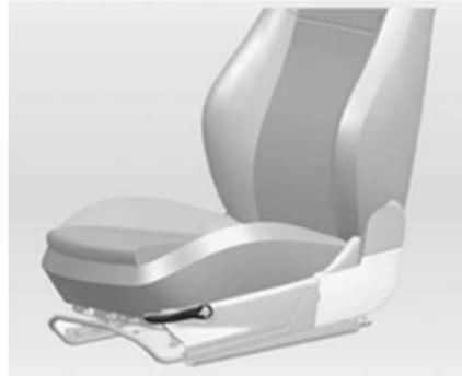
Jale la palanca hacia arriba y retire el peso del asiento para levantarlo. Jale la palanca y empuje el asiento hacia abajo para bajarlo. Ajuste el cojín del asiento a la altura del conductor para ajustar los pedales y el volante de dirección.
